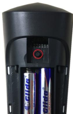
取下电池后盖，长按“RESET”键（图中红圈处），待红/蓝色指示灯交替闪烁3次后指示灯熄灭，此时即表示恢复出厂状态完成。
