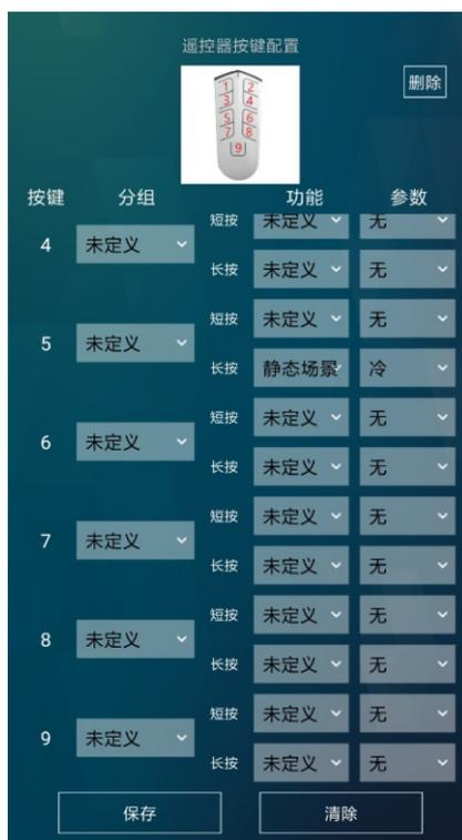
步骤3：定义完成各按键的功能后，长按按键“1”和“2”进行配置模式，点击“保存”和“确定”，待红灯持续闪烁结束，表示按键配置完成。
